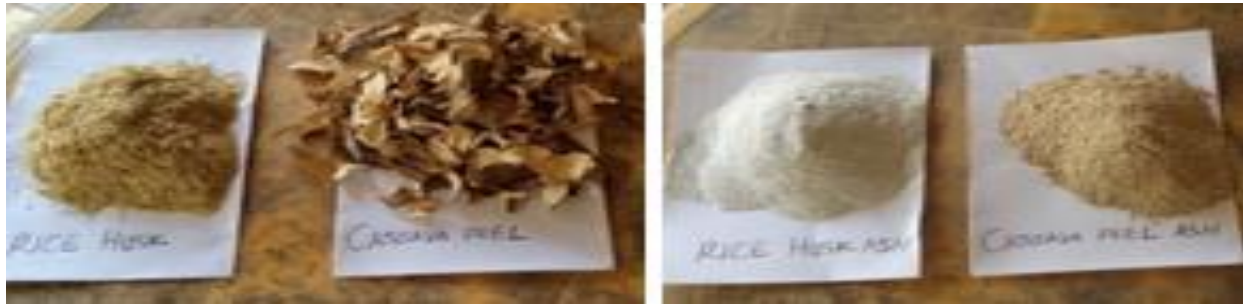
Fig. 1: (a) Rice husk (b) Cassava peel (c) RHA (d) CPA
